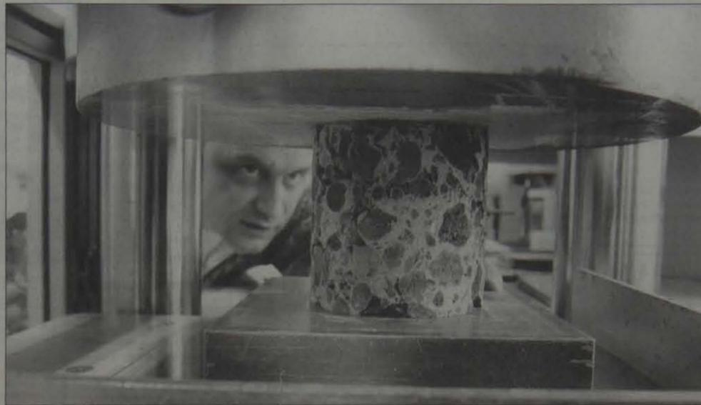
Prüfingenieur Thomas Kuban von der Materialforschungs- und Prüfungsanstalt für Bauwesen in Engelsdorf prüft die Festigkeit des neuen Hochleistungsbetons. Mit bis zu 300 Tonnen Gewicht kann die Maschine die Belastungsfähigkeit des Baustoffs testen. Fotos: Kay Schönenerk(2)
