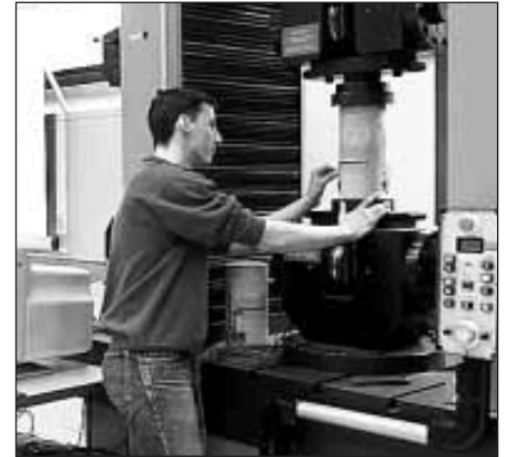
Harte Prüfung: Beton-Drucktest im Labor der HTWK. Foto: A. Kempner
