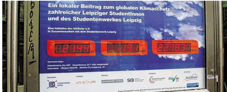
Auf der elektronischen Anzeigetafel am Geisteswissenschaftlichen Zentrum ist zu sehen, wieviel Strom auf dem Dach produziert wird.
